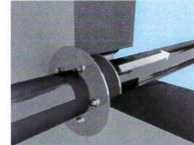
Dichtungseinsatz auf das Rohr/Kabel aufschieben und mit dem Großflansch zur Wasserseite montieren. Der Großflansch muss an der Wand anliegen. Ansicht Keller-Außenseite (Erdreich).
