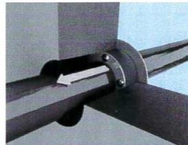
Dichtungseinsatz auf das Rohr/Kabel aufschieben und mit dem Großflansch zur Wasserseite montieren. Der Großflansch muss an der Wand anliegen. Ansicht Keller-Innenseite.
