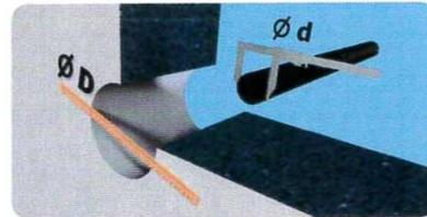
3. Überprüfung der Durchmesser von Kernbohrung oder Futterrohr auf Maßhaltigkeit. Durchmesser der Medienleitungen Rohre und Kabel mit den Angaben auf dem Dichtungseinsatz abgleichen.
