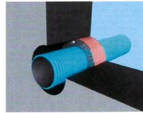
Soft-Flexible Dichtungseinsatz auf das Rohr/Kabel aufschieben. Weitere Montage wie Bild 4-6. **Achtung verringerte Drehmomente.**
