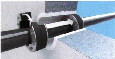
Geteilten Dichtungseinsatz aufklappen um das Rohr/Kabel herumlegen, schließen und aufschieben. Weitere Montage wie Bild 5-6.
