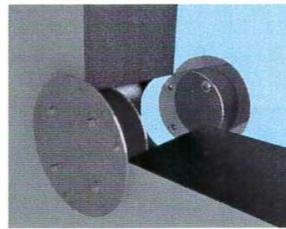
Blind-Dichtungseinsatz mit Großflansch in die Wand einsetzen. Der Großflansch muss an der Wand anliegen. Ansicht Keller-Innenseite.
