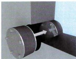
Blind-Dichtungseinsatz in die Wand einschieben. Möglichst Wand bündig zur Wasserseite montieren. Ansicht Keller-Innenseite.
