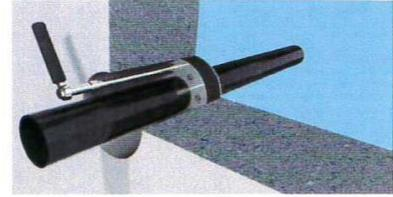
6. Den Dichteinsatz durch leichtes mehrmaliges anziehen der Muttern über Kreuz fixieren. Danach bis zum maximalen Anzugsmoment/Drehmoment den Vorgang wiederholen. Siehe Tabelle.
