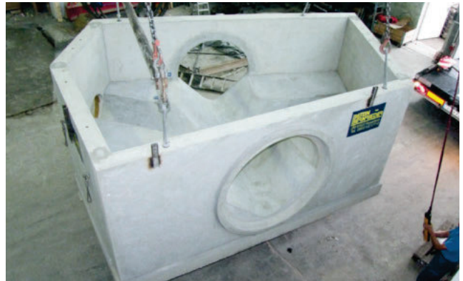
Zulaufbauwerk in Wasserburg
