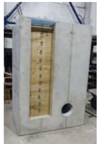
mit Staubohlen und Grundablasschieber
