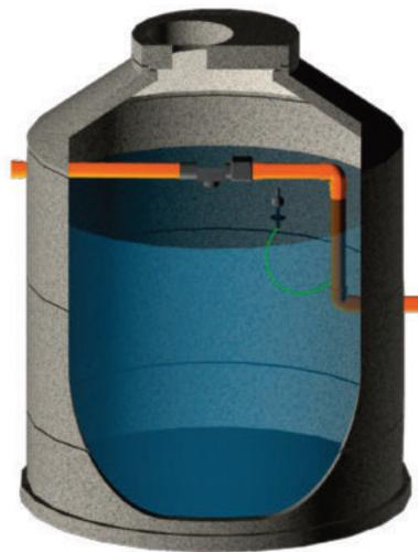
Retentionsschacht mit eingebautem AlphaClean 100 Filter
