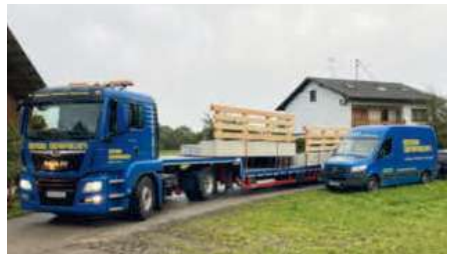
die 2-teilige Ausführung reduziert die Transportbreite
