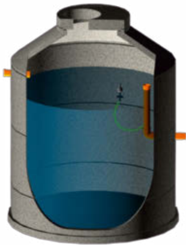
Retentionsschacht mit Retentionsdrossel
