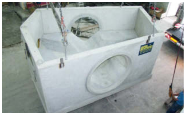
Zulaufbauwerk in Wasserburg
