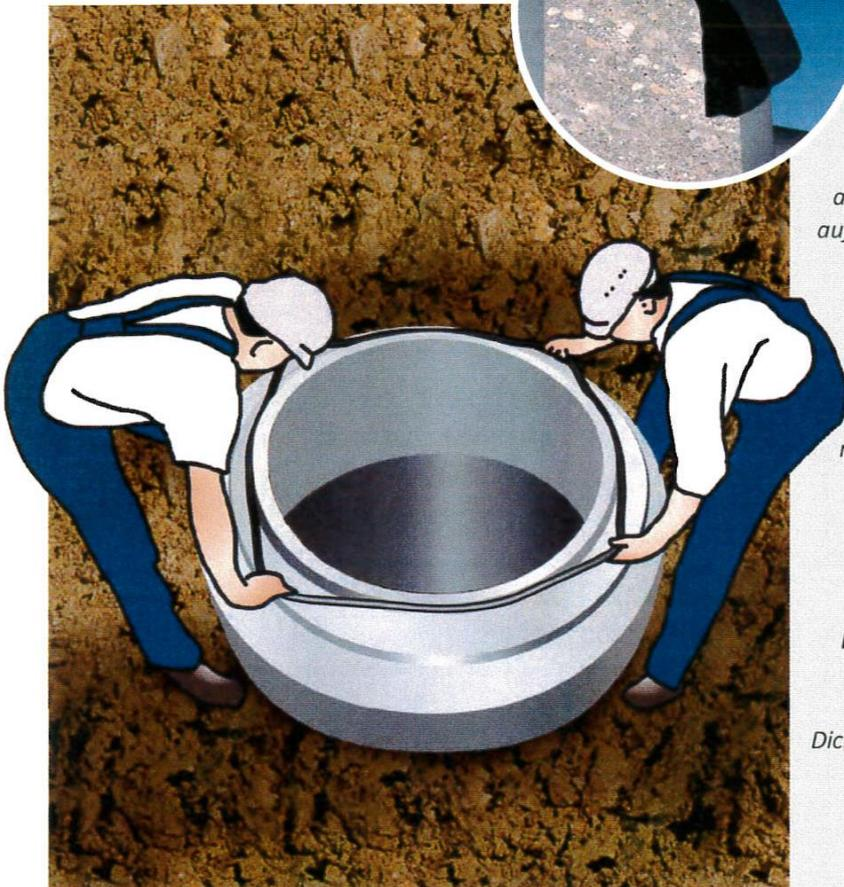
**1.** Dichtung – Gleitmantel nach oben und außen zeigend – auf das saubere Spitzende aufziehen, Vorspannung durch mehrfaches Ziehen an verschiedenen Stellen gleichmäßig verteilen und auf richtigen Sitz der Dichtung an der Schulter sowie des Lastausgleichs mittig auf dem Spitzende achten.
