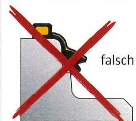
**2.** Schachtring zentrisch und gerade hängend aufsetzen und aufgleiten lassen.
